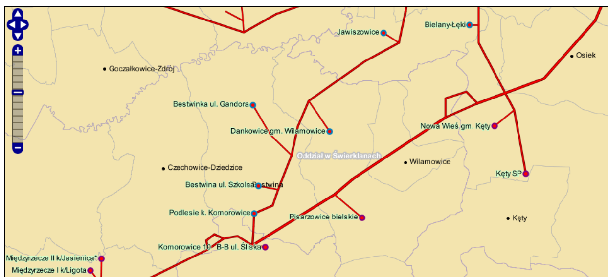
Rysunek 10. Stacje redukcyjno-pomiarowe zasilaających teren Gminy Wilamowice
